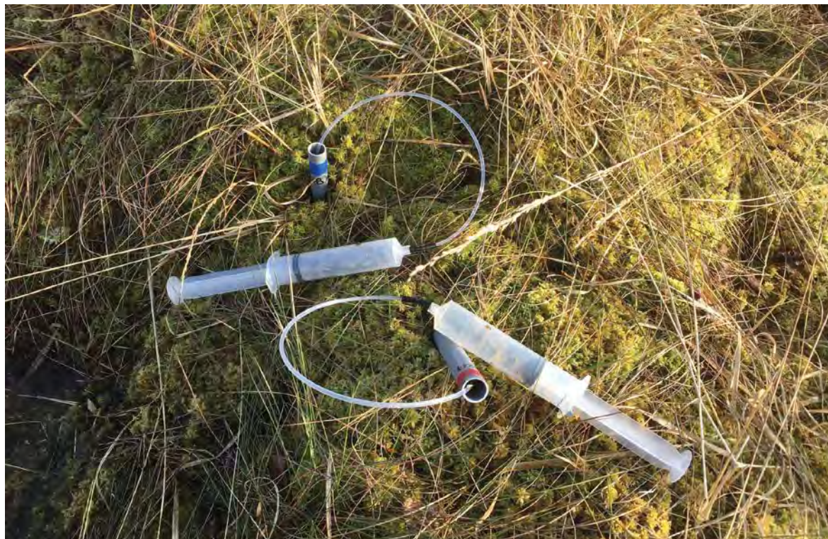
Figuur 6. Foto van de bemonstering van de keramische cups onder vacuüm met behulp van injectiespuiten.
