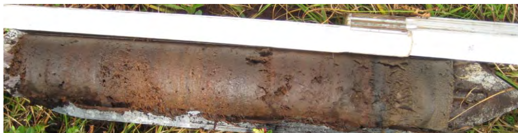
Figuur 9 Basis van het veen (rechts) op minerale ondergrond zoals waargenomen bij het veldwerk op boorlocatie P2.
